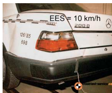
BILD 16: Links- und rechtsseitige Belastung eines Mercedes W 124
