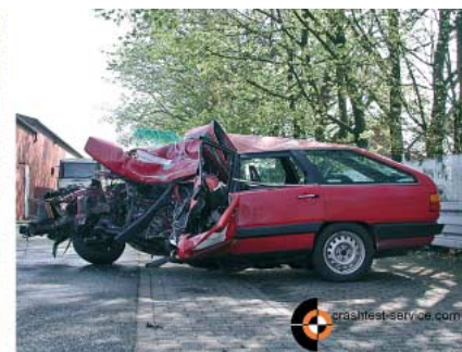
BILD 15: Passender Hochgeschwindigkeitsversuch (EES = 87 km/h)
