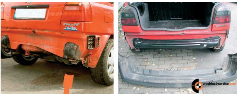
BILD 10: Pralltöpfe und Prallelemente beim VW Golf III
