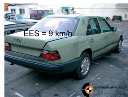
BILD 16: Links- und rechtsseitige Belastung eines Mercedes W 124
