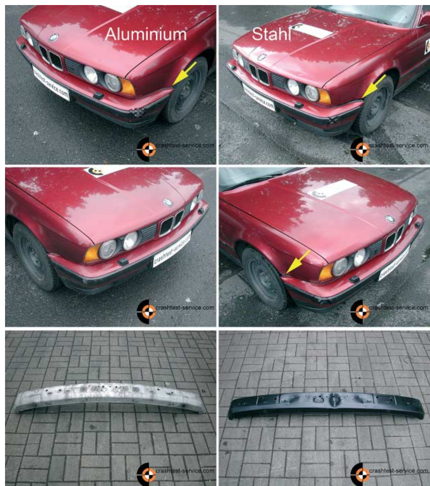
BILD 22: Versuche mit Aluminium- und Stahlträger
