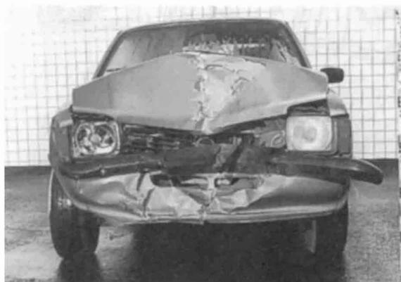
Versuch 13:  $v_{\text{gestoßen}} = 18 \text{ km/h}$  ----->
