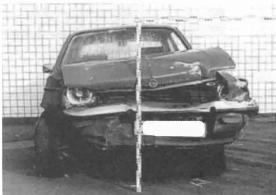
Versuch 05:  $v_{\text{gestoßen}} = 18 \text{ km/h}$  ----->
