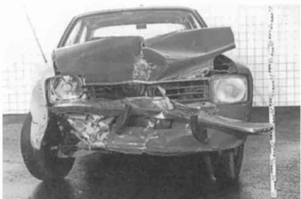
Versuch 12:  $v_{\text{gestoßen}} = 14 \text{ km/h}$  ----->
