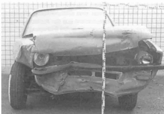
Versuch 06:  $v_{\text{gestoßen}} = 21,5 \text{ km/h}$  ----->
