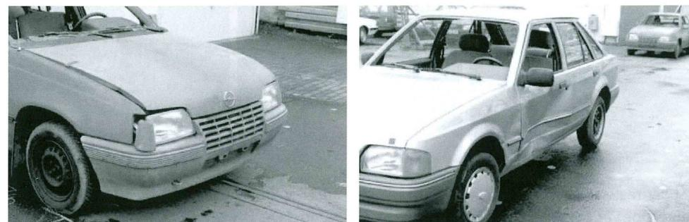
Aus den **Schadenausprägungen** ist jedoch ein Stillstand des Ford zum Zeitpunkt der Kollision abzuleiten. Die Front des Opel zeichnete sich stempelförmig an der Flanke des Ford ab. Die Kontaktbreite an der Flanke ist mit der Frontbreite identisch. Der Anstoß erfolgte ungebremst.
