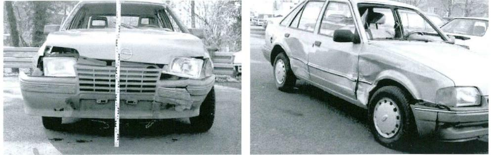
Innerhalb der Kollisionsdauer von 0,11 s bewegt sich das querende Fahrzeug notwendigerweise weiter. Hierdurch müssen an der Flanke horizontal ausgerichtete Streifspuren zurückbleiben. Die Kontaktbreite steht dabei in direkter Proportion zur Geschwindigkeit des Ford.
