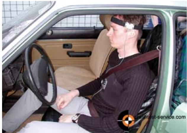
BILD 8: Proband mit Beschleunigungssensoren
