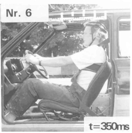
Bild 2 Bildsequenz der Insassenbewegung nach einem Lkw-Heckanstoß
