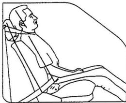
3 Der maximale Relativwinkel zwischen Kopf und Rumpf des Insassen wird unmittelbar vor dem Kontakt mit der Kopfstütze erreicht. Nach dem Kontakt folgt auch der Kopf der allgemeinen Vorwärtsbewegung.
