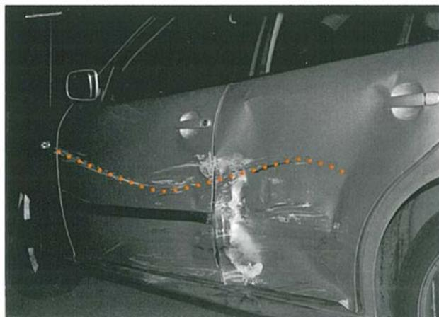
Abb. 2: Wellenförmige Kratzspur am geparkten Seat
