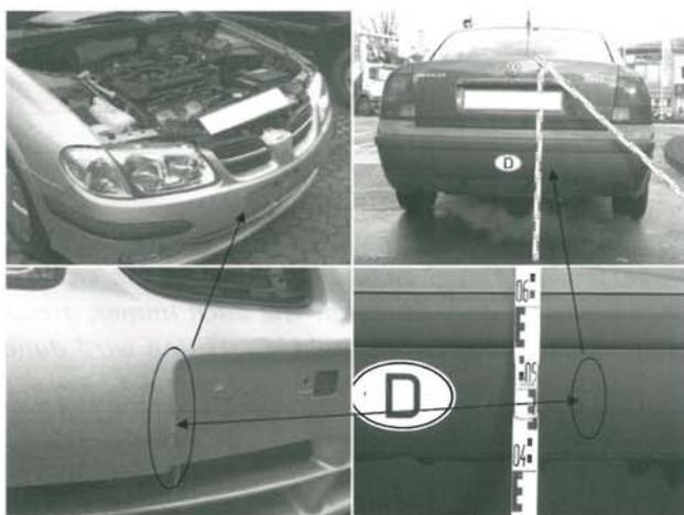
Abb. 2 Korrespondierende Kontaktpuren an beiden Stoßfängern
