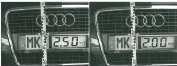
Abb. 5 5 mm Höhendifferenz bei 0,5 bar geringerem Luftdruck
