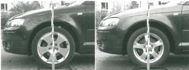
Abb. 4 Nahezu identische Höhe der Radlaufkante bei Sommer- und Winterreifen
