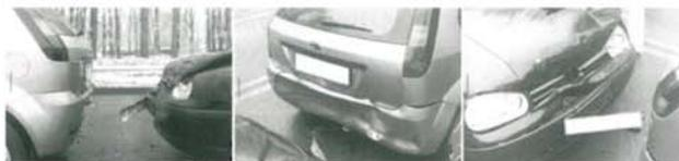
Abb. 1 Gebremst aufgefahrenes Fahrzeug (Relativgeschwindigkeit ca. 25 km/h)
