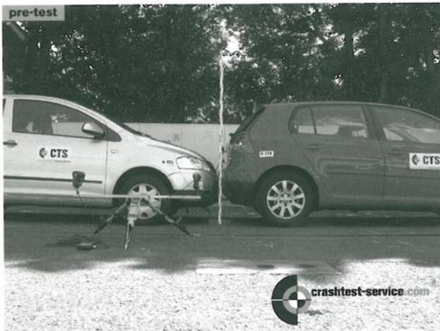
Abb. 8: Relativgeschwindigkeit 4,5 km/h,  $k = 0,71$  [3]
