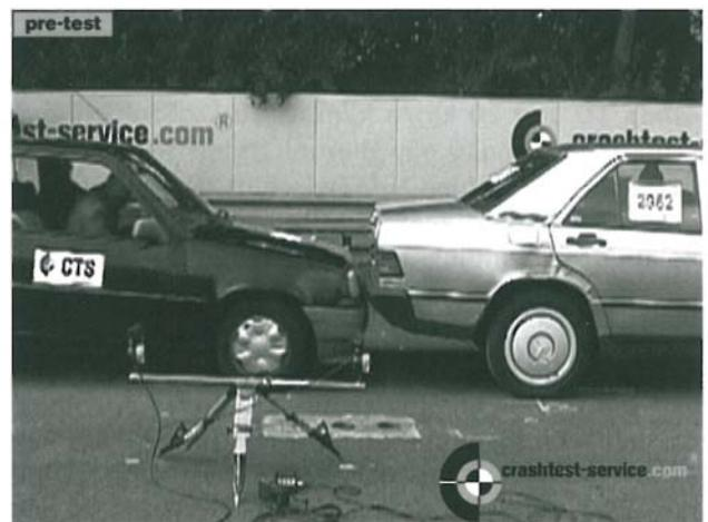
Abb. 7: Relativgeschwindigkeit 18 km/h,  $k = 0,40$  [3]
