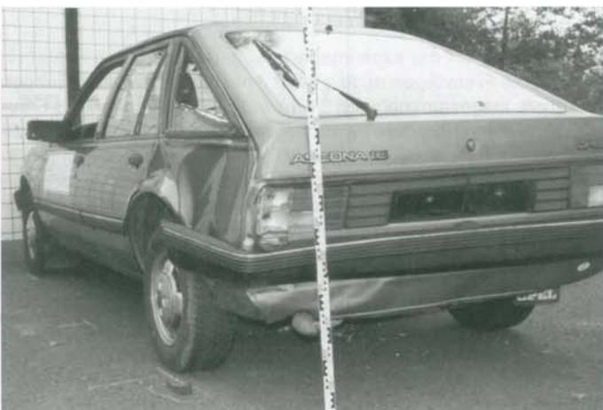
Bild 2 Versuchsschäden ( $v_1$  | 20 km/h,  $\Delta v_1 = -9,6$ ,  $\Delta v_2 = 13$  km/h)
