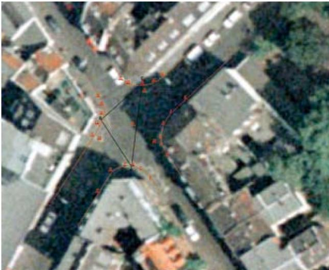
**BILD 9:** Dreiecksmessverfahren mittels Lasermessstisch
