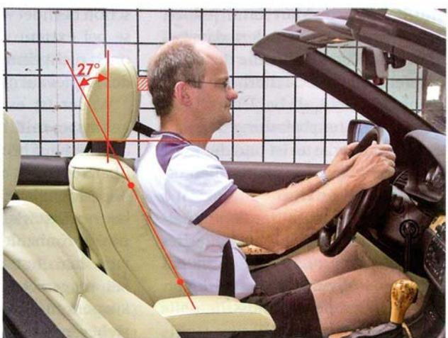
BILD 4: Einfluss der Rückenlehnenneigung auf den Abstand Kopf/Kopfstütze
