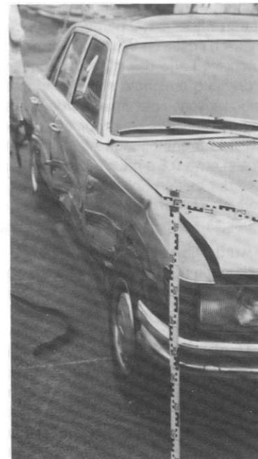
Bild 9 Deformation am gestoßenen Mercedes beim Einbiegeversuch
